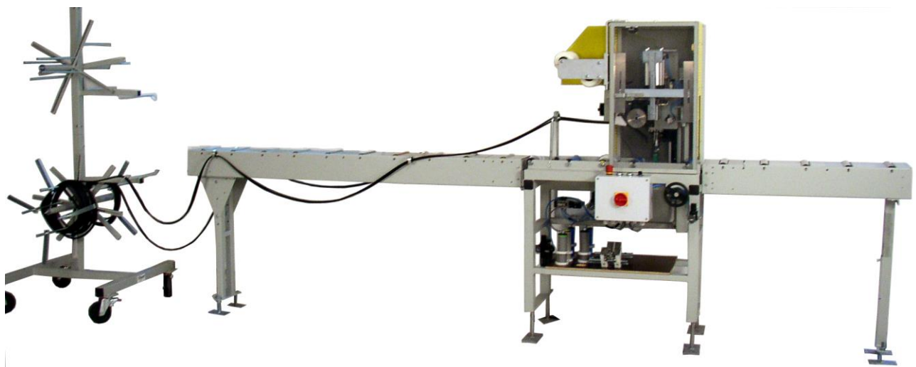
Einrollvorrichtung RU-EV-HS mit 4-fach Haspelwagen, 3 Meter Rollenbahn im Zufuhr- und 2 Meter Rollenbahn im Abfuhrbereich.
