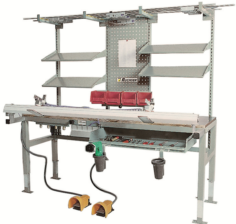
Türstabmontagetisch ohne Türbandbohrwerk.
